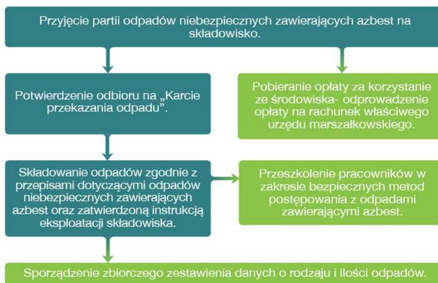
Rycina 10 Procedura 6 - dotycząca składowania odpadów na składowisku przeznaczonym do wyłącznego składowania odpadów zawierających azbest lub innym, spełniającym odpowiednie warunki techniczne
