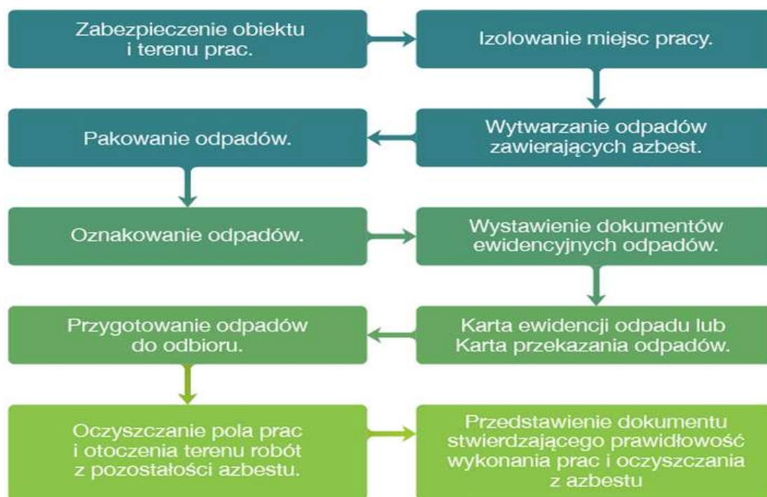
Rycina 8 Procedura 4 - dotycząca prac polegających na usuwaniu wyrobów zawierających azbest - wytwarzaniu odpadów niebezpiecznych, wraz z oczyszczaniem obiektu (terenu) instalacji
