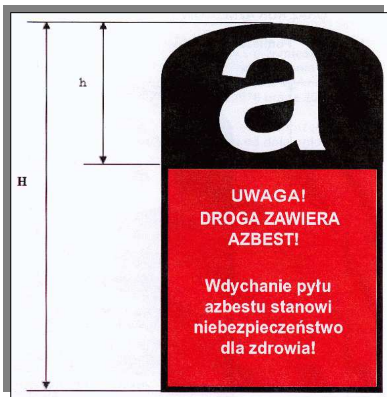
Rycina 21 Wzór oznakowania dróg utwardzonych odpadami zawierającymi azbest przed wejściem w życie ustawy z dnia 19 czerwca 1997 r. o zakazie stosowania wyrobów zawierających azbest, ale niezabezpieczonych trwale przed emisją włókien azbestu
